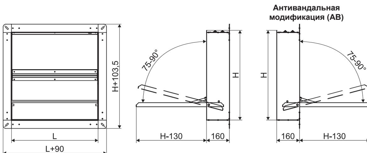
Минимальный размер клапана (L\*H) - 300\*300 мм, далее с шагом 50 мм в соответствии с таблицами типоразмерного ряда и значения площади живого сечения клапанов ДМУ.
