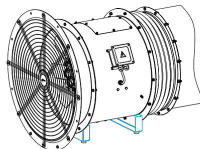
3.1.2 Виброопоры ЕС предназначены для предотвращения распространения вибрации. Виброопоры устанавливаются и закрепляются между монтажной опорой МОП и основанием.
