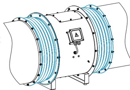
3.1.4 Переходник РОСА предназначен для жесткого соединения осевого вентилятора РОСА с системой воздуховодов.
