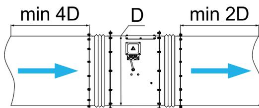
Предусмотреть прямолинейные участки воздуховодов достаточной длины на входе и выходе вентилятора ( $4D$  и  $2D$ , где  $D$  - диаметр колеса вентилятора) с площадью поперечных сечений, равной площади входного и выходного сечения вентилятора. Для снижения вибрации и шума установить гибкие вставки на входе и выходе вентилятора.
