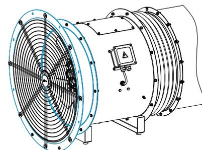
3.1.6 Решетка БАКЕТ-РОСА предназначена для защиты осевого вентилятора и системы вентиляции от попадания в них посторонних предметов.
