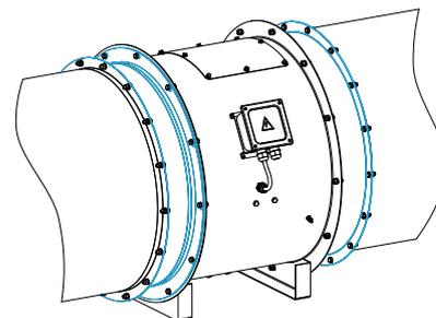
3.1.5 Входной осевой коллектор ВКО-РОСА предназначен для установки на вентилятор РОСА в корпусе 10 типа.
