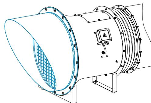
3.1.8 Клапаны лепестковые КЛ-РОСА предназначены для установки на нагнетательной стороне осевых вентиляторов РОСА с целью предотвращения попадания холодного воздуха и атмосферных осадков в производственные помещения после отключения вентиляторов.
