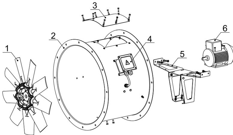
1 – рабочее колесо (крыльчатка осевая); 2 – корпус; 3 – крышка;
