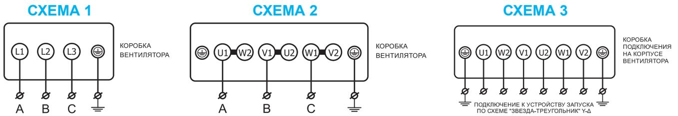
**СХЕМА 1**: для двигателей Δ/Y 220/380В стандартное подключение Y (звезда);
