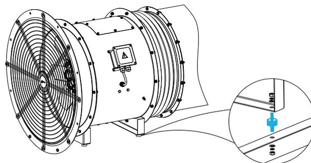
3.1.3 Вставки гибкие круглые ВГК-РОСА предназначены для предотвращения передачи вибрации от вентилятора к воздуховоду.
